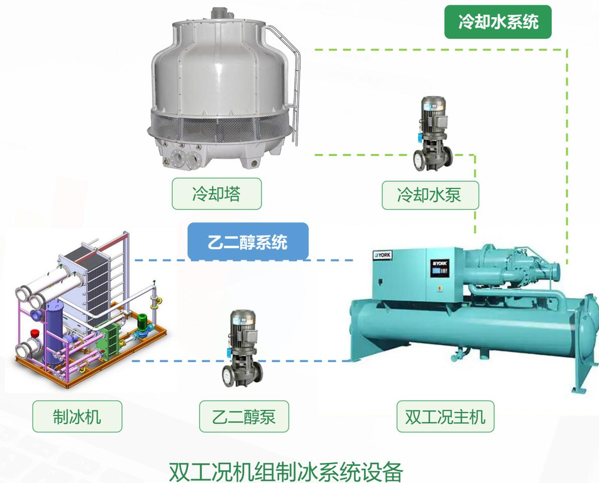
省去了冷去水系统及部件的使用、乙二醇系统及部件的使用，高度集成在一台设备中，减少了初期投资及安装费用的投入。
